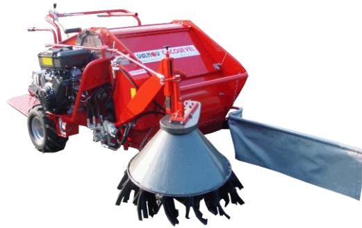
Figuur 4 Opraapmachine voor hazelnoten. De noten (en bladeren) worden op stroken geveegd en opgenomen (Bron: Cacquevel, Frankrijk).
