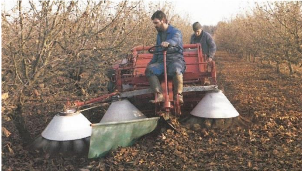
Figuur 4 Opraapmachine voor hazelnoten. De noten (en bladeren) worden op stroken geveegd en opgenomen (Bron: Cacquevel, Frankrijk).
