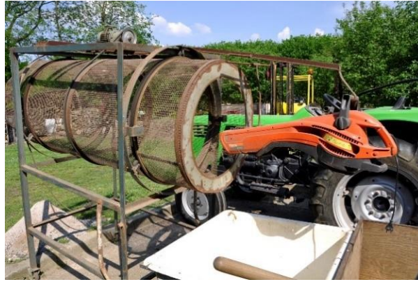
Figuur 6 Met behulp van deze eenvoudige opstelling van een cilindervormige zeef, bladblazer en een bak met water worden de noten gereinigd.
