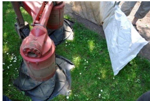
Figuur 5 Links: Boomgaard bij hazelnotenkwekerij 'Het Joostenhuus'; Rechts: Zelf ontwikkelde machine waarmee de noten door twee ronddraaiende rubberen vegers in een rij op de zwartstrook worden verzameld.
