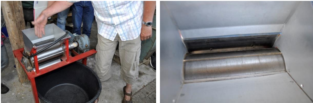
Figuur 31 & 32 De notenkraaker die Harm ontwikkelde wordt aangedreven door een elektrische motor. De noten worden bovenaan ingevoerd, waarna ze door de ronddraaiende rol en de wand gekraakt worden. Afhankelijk van de grootte van de noten kan de breedte tussen de rand en de rol worden afgesteld.
