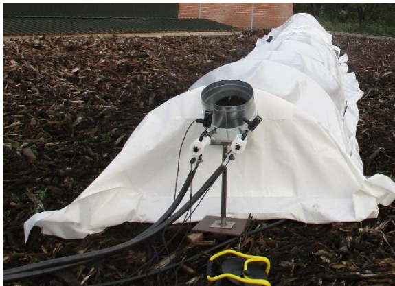
Figuur 3: Opstelling met tent voor NH 3 -metingen op een biobed.
