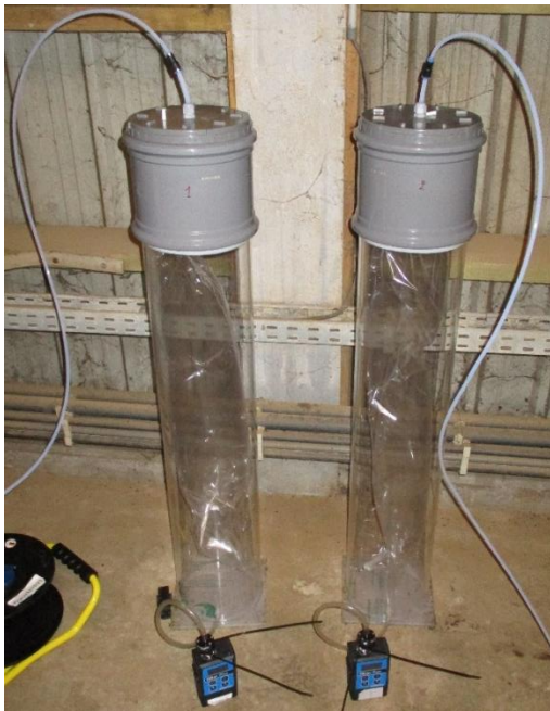
Figuur 5: Opstelling voor geurstaalname volgens het longprincipe.
