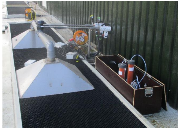
Figuur 4: Opstelling met kappen voor NH 3 -metingen op een luchtwasser.
