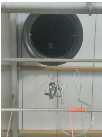
Katrolsysteem voor staalname fijn stof van de stallucht
