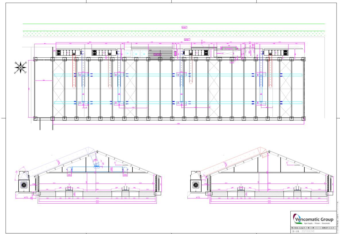
Figuur 30: Plattegrond en technische tekening van de stal
