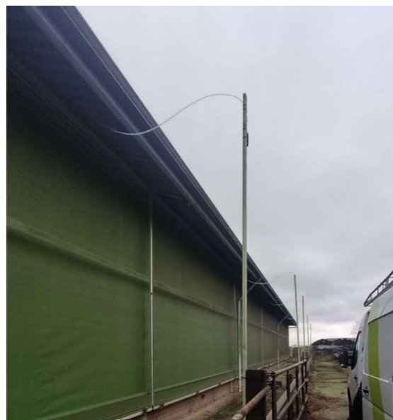
Figuur 15: (links) Foto van 1 staalnamepunt buiten de stal in centrum van zijopening, (rechts) foto van verzamelleiding buiten de stal.
