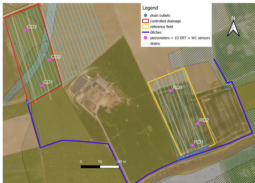
Figuur 68: Ligging van de proefvelden, samen met de positie van elk meetpunt en de drainagebuizen. In transparante overlay staat het bodemtype volgens de Belgische bodemkaart.
