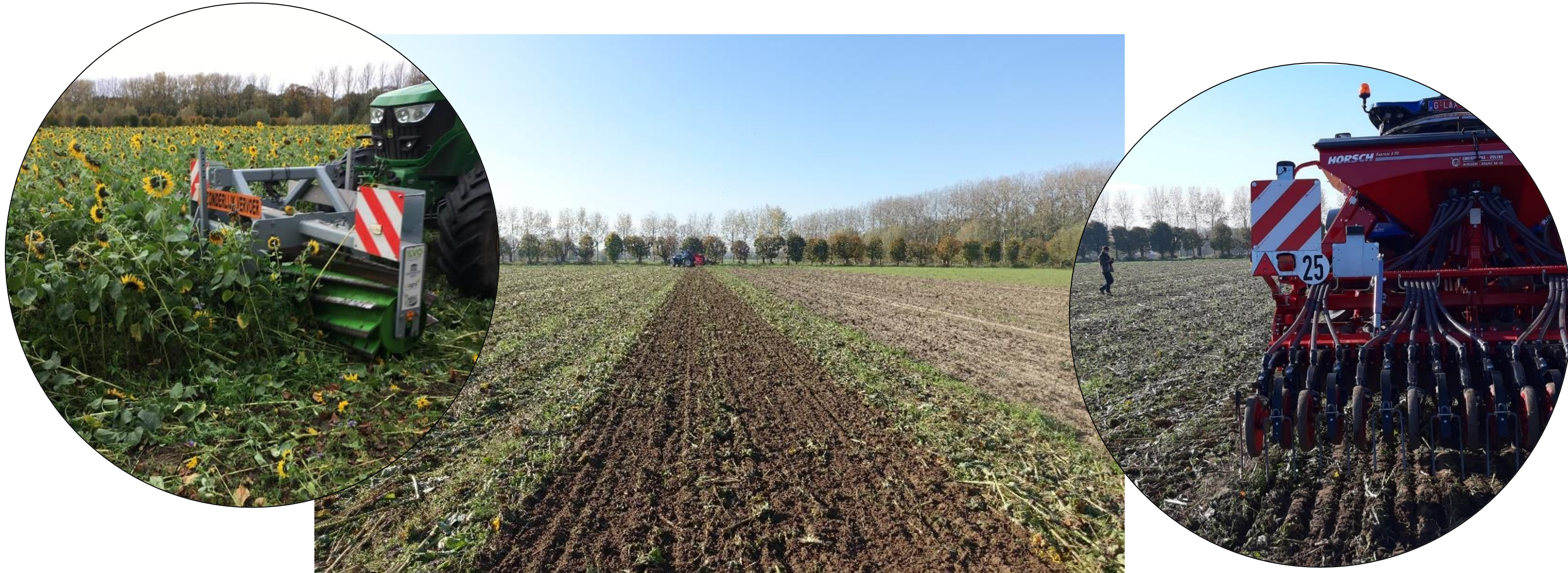
Inzaai baktarwe in Biomax stoppel met Horsch Express 3TD zaaimachine
