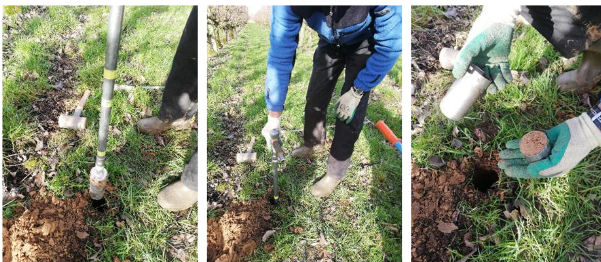
Figuur 4: Bodemstaalname voor het bepalen van de bulkdensiteit. Bemonsterde dieptes in cm: (0-30) (30-60) & (60-90).
