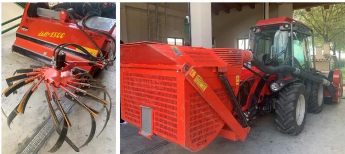
Figuur 16. Mechanische oogstmachine Jolly 1800 van GF Meccanica met laterale borstel die de noten richting de rapers veegt. In dit geval worden de geraapte noten worden via een slang naar een opvangbak vooraan de tractor gezogen.
