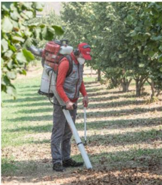
Figuur 20. Links: notenzuiger V1200E van het merk Cifarelli Spa®, hier op de rug gedragen en gebruikt om hazelnoten op te zuigen. Rechts: T2 oogstmachine van Aydinmaksan®.
