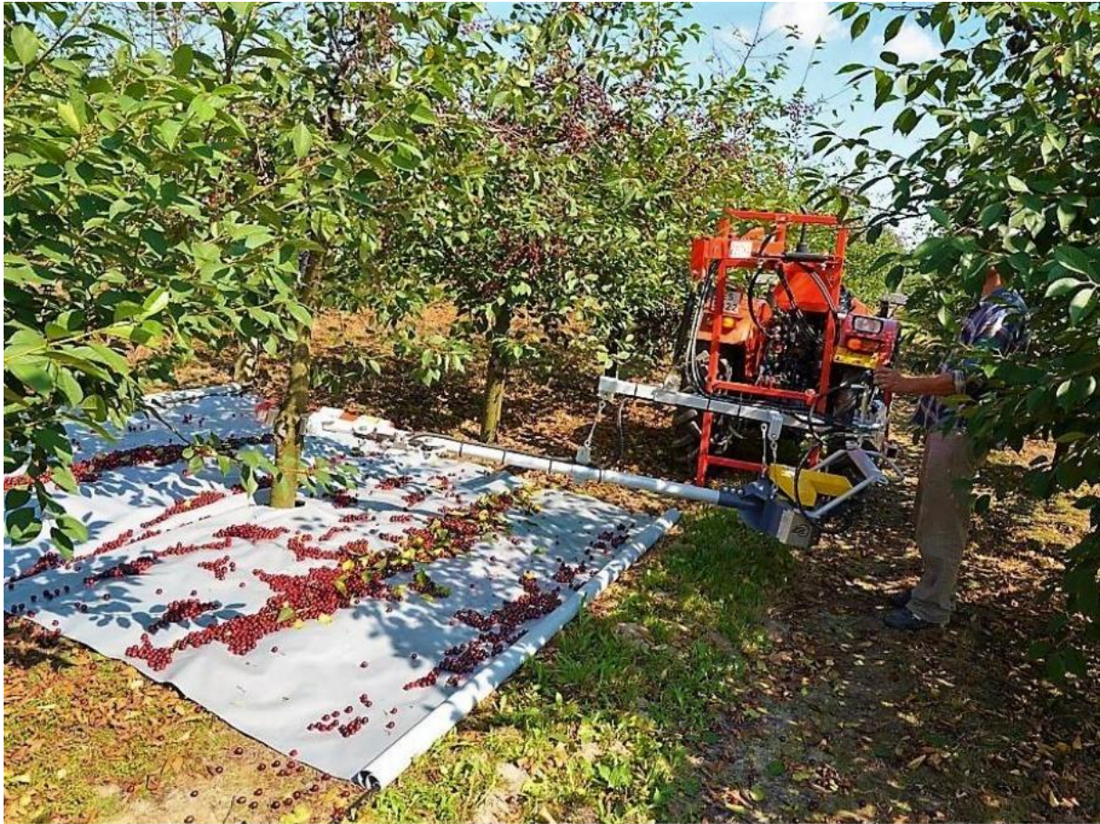
Figuur 6. Stamschudder ©Jagoda JPS, hier gebruikt voor het oogsten van kersen.
