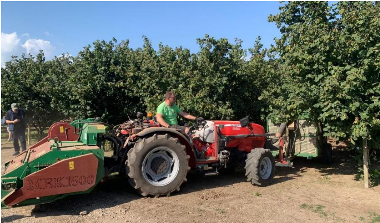
Figuur 17. Mechanische opraper MEK1600 van FACMA met opvangbak vooraan de tractor.
