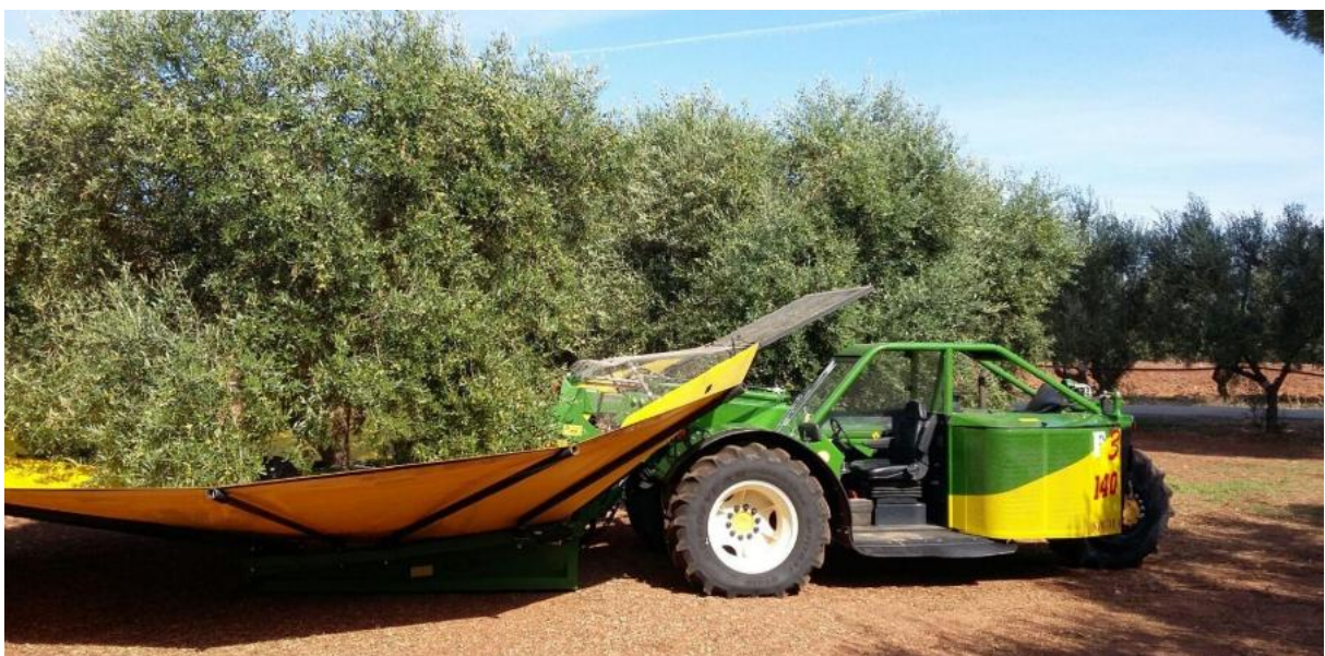
Figuur 7. F3 stamschudder met oogstparaplu van ©SICMA, hier te zien bij olijf.
