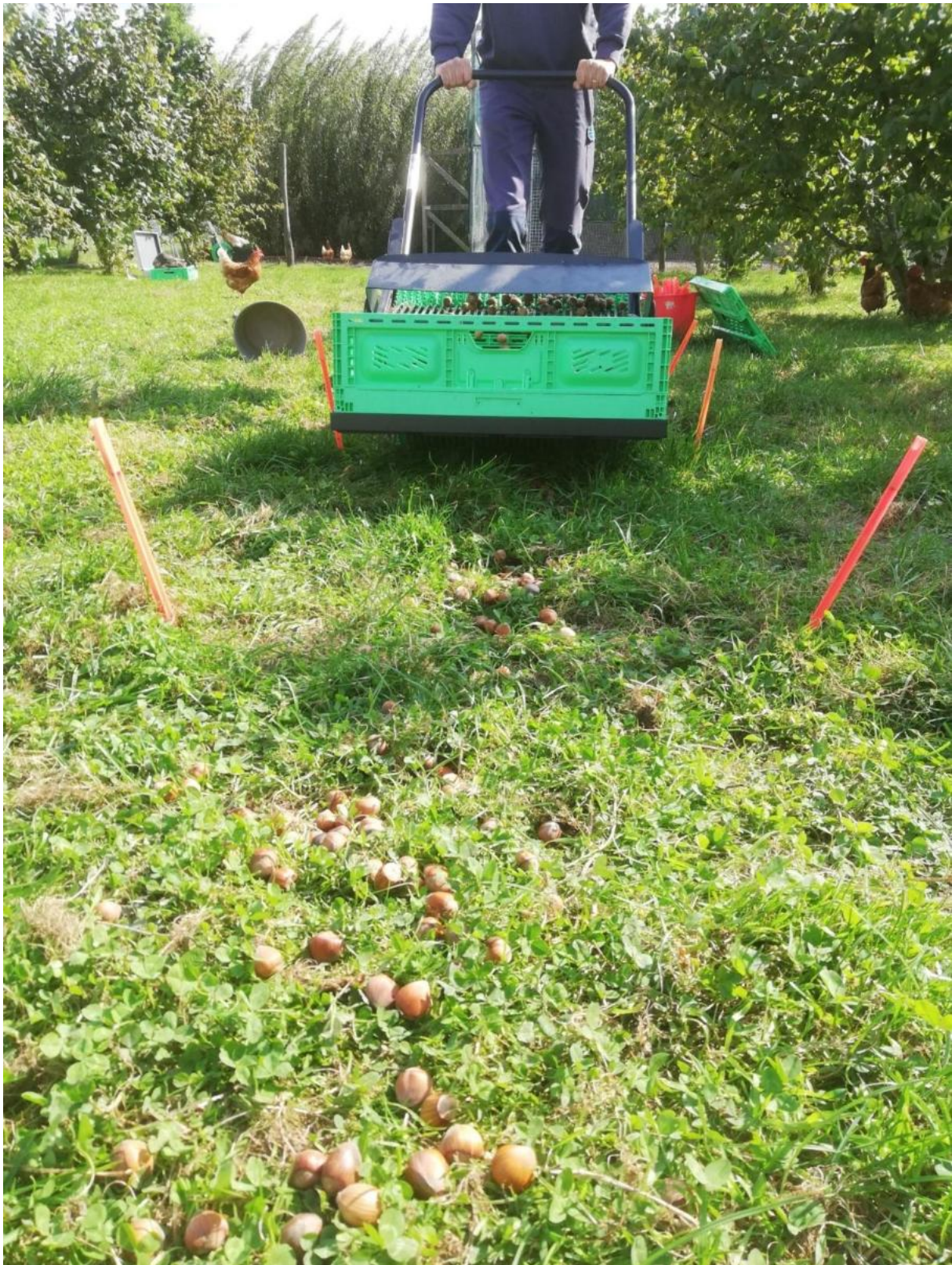
Figuur 13. Hazelnootoogster van Bag-A-Nut uitgetest op in een vrije uitloop met hennen. Hazelnoten in kuiltjes of tussen hoger gras worden moeilijk opgepikt.
