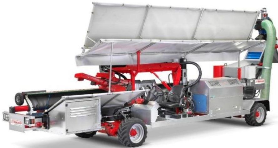
Figuur 8. Volautomatische stamschudder van het bedrijf ©Munckhof Fruit Tech Innovators.
