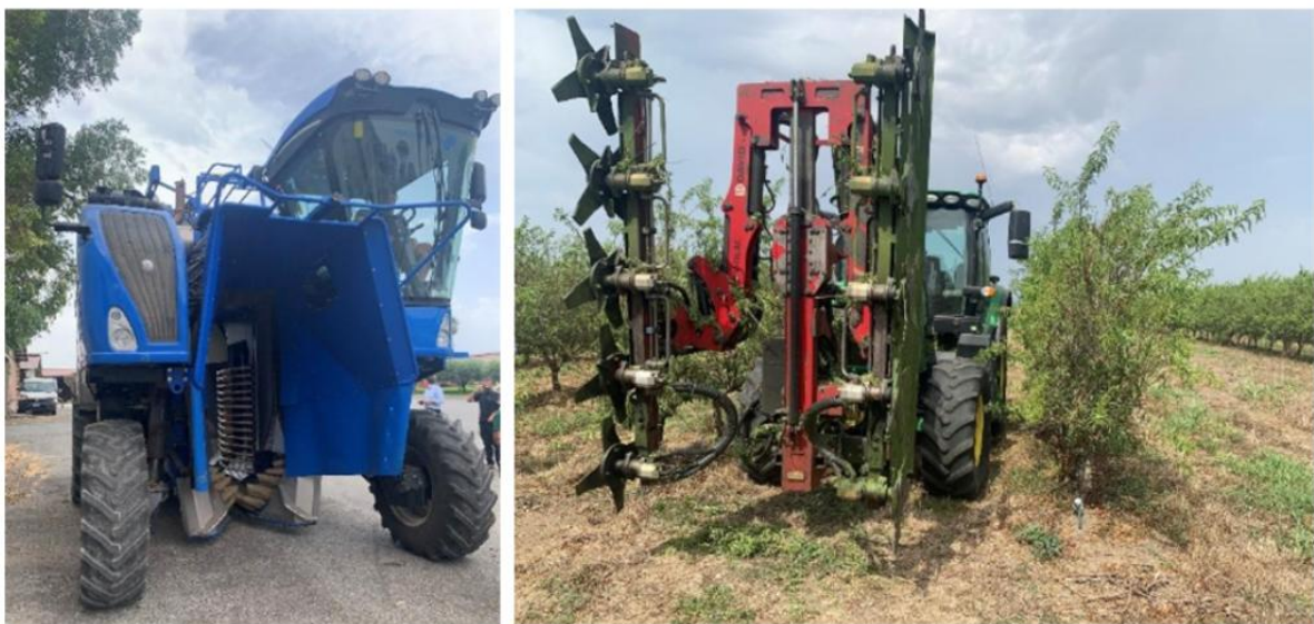
Figuur 9. Links: straddle harvester Multi van New Holland, gezien bij Azienda Agricola Maccaresse in Italië waar amandelen in haagsystemen groeien (rechts) die machinaal geoogst en gesnoeid worden.
