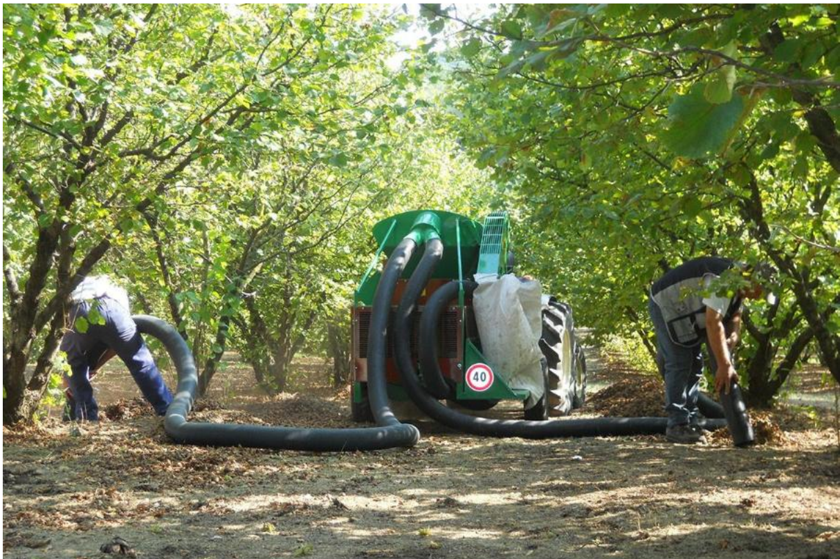
Figuur 21. CIMINA C120T oogstmachine van FACMA, hier gebruikt voor het opzuigen van hazelnoten (©FACMA).
