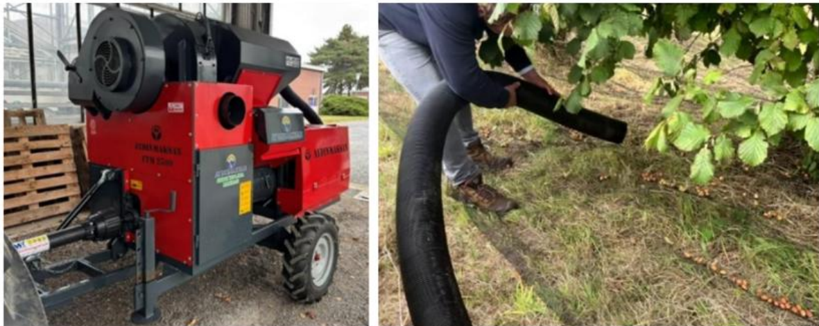
Figuur 22. FTM-2500, tractorgedreven notenzuiger van Aydinmaksan met zuigslang. Om ergonomische te werken is het belangrijk om de slang te bevestigen in een soort houder zoals bijvoorbeeld bij Cifarelli Spa, of een handvat te voorzien.
