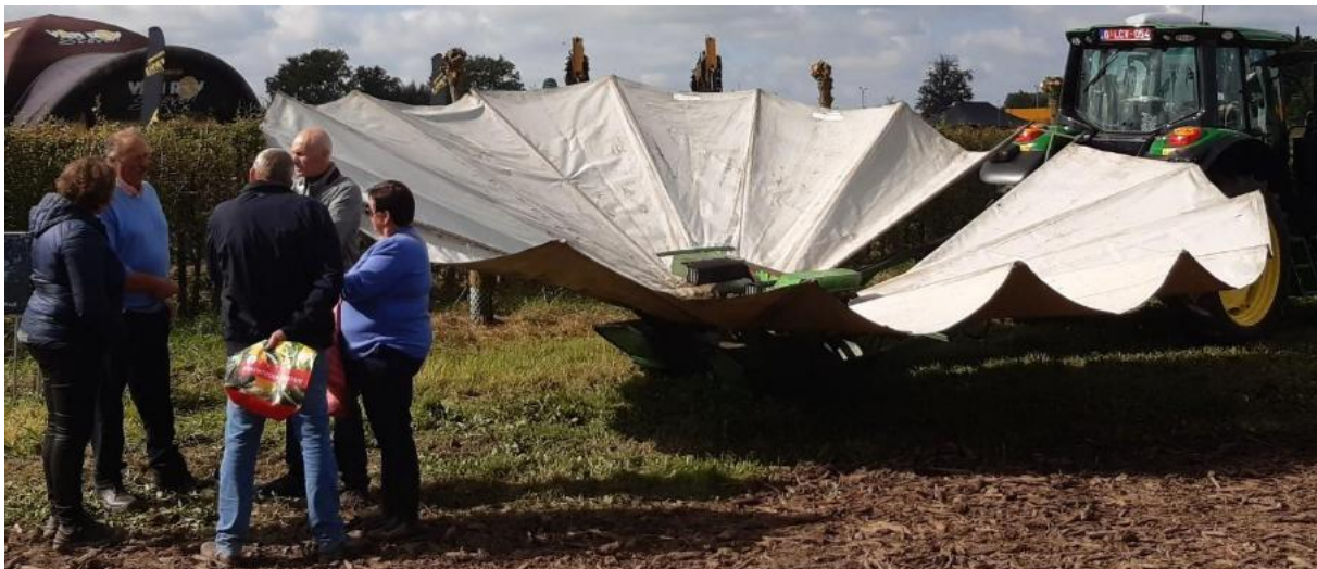
Figuur 2. Oogstparaplu met gecombineerde stamschudder van bedrijf Lerouge gepresenteerd op de Werktuigendagen in Oudenaarde.
