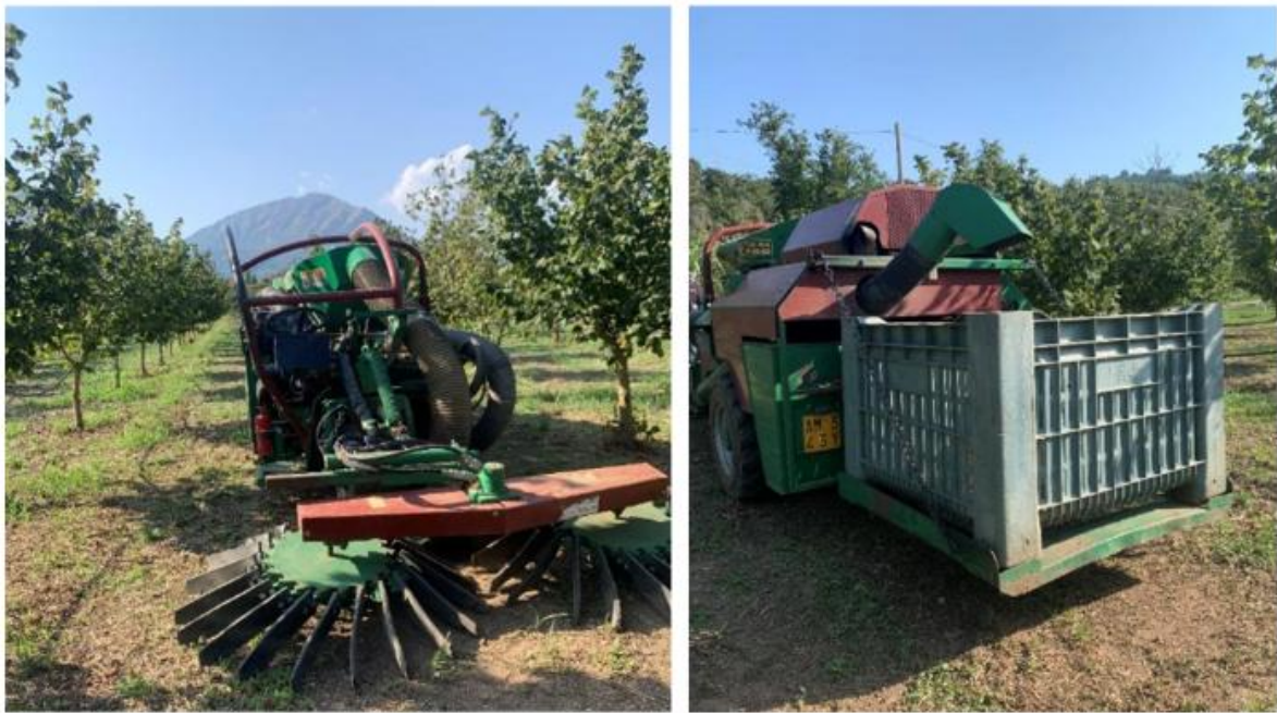
Figuur 24. FACMA Cimina C200S mechanische autonoom aangedreven zuiger met extra mechanische raapkop RM170. Achteraan komen de noten terecht in een palletbox.
