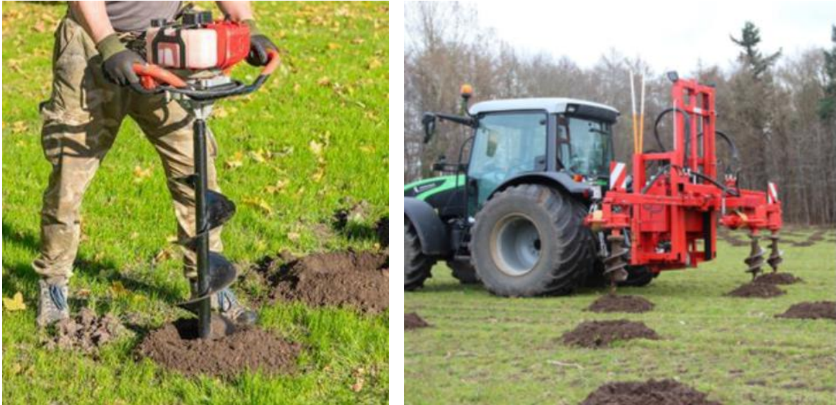
Figuur 4. Links: Grondboor op benzinemotor (© www.tipsvoorgereedschap.nl ). Rechts: Hydraulische grondboor bevestigd op tractor (Deutz Fahr 5080 D GS), uitgerust met RTK GPS, volautomatisch. Plantafstand in de rij vanaf 0,5 m. Plantafstand tussen de rijen met 2 boren min 2m en max 4m. Plantafstand tussen de rijen met 3 boren min 1,25m en max 2m. Mogelijkheid tot wildverband boren op GPS. Boordiepte tot 40cm. (© bomenplanter.be )
