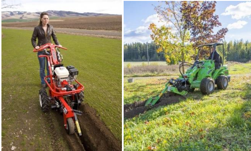
Figuur 5. Links: manueel bediende sleuengraver (@ interrent.be) – Rechts: volledig mechanische sleuengraver (@ avanttechno.com).
