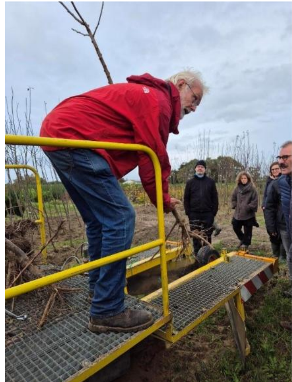
Figuur 7. Twee types plantmachine bevestigd aan de tractor, voor machinale aanplant zonder voorafgaande bodembewerking. In beide gevallen wordt een sleuf getrokken, het plantgoed manueel in de sleuf gestoken (via het zit- of sta platform) en wordt de sleuf daarna terug gedicht. Boven: planttoestel (© Esberghoeve.be). Onder: plantmachine van Calle Plant © Calle Plant.
