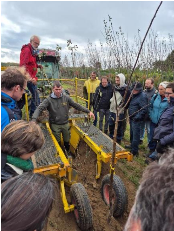
Figuur 7. Twee types plantmachine bevestigd aan de tractor, voor machinale aanplant zonder voorafgaande bodembewerking. In beide gevallen wordt een sleuf getrokken, het plantgoed manueel in de sleuf gestoken (via het zit- of sta platform) en wordt de sleuf daarna terug gedicht. Boven: planttoestel (© Esberghoeve.be). Onder: plantmachine van Calle Plant © Calle Plant.
