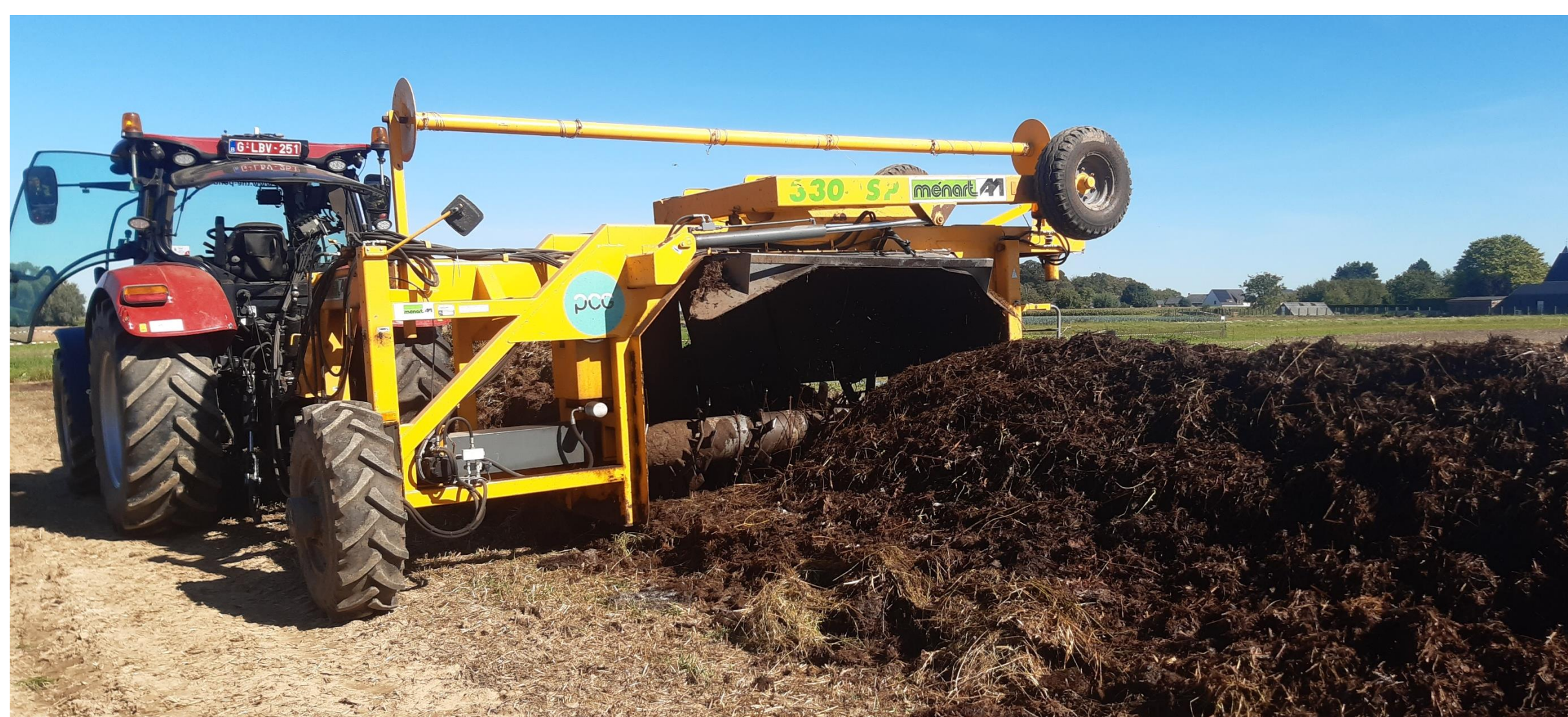
1 ste maal omzetten met compostkeerder
