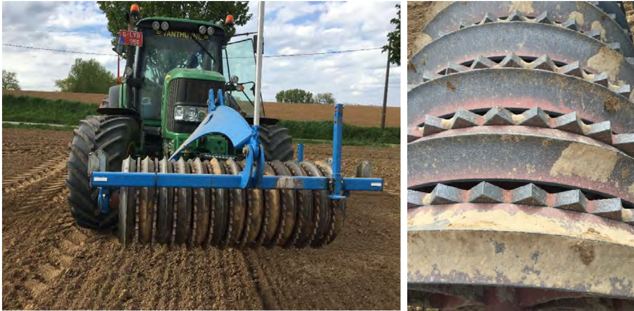
Figuur 4-9: Cambridgerol vooraan de trekker als frontgewicht en om grond aan te drukken en te verkruiden.
