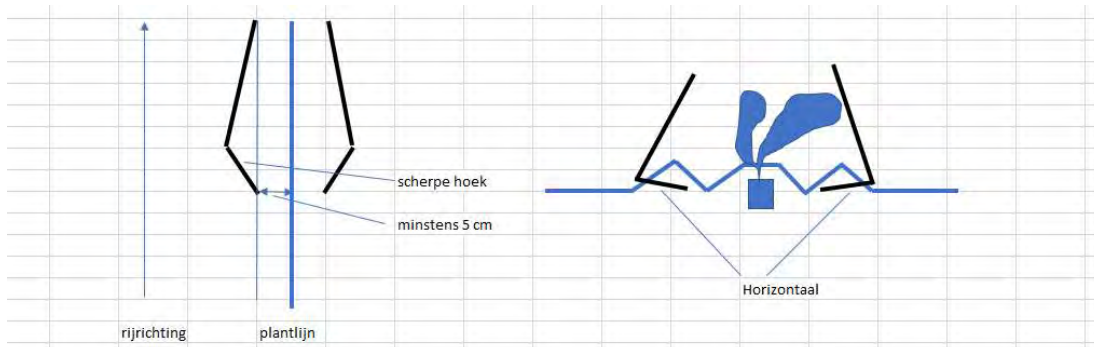
Figuur 7.8: Optimale manier om de torsiewieders op de plantmachine te monteren.
