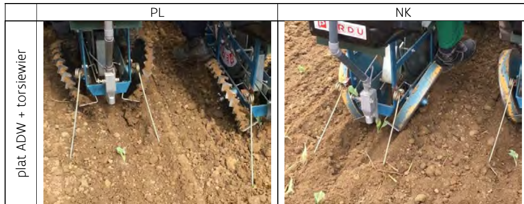
Figuur 8-7: Overzicht van de geploegde behandelingen (PL) in de linker kolom en de niet-kerende behandelingen (NK) in de rechter kolom samen met de aanpassingen aan de planter, nl. plat aandrukwielen (ADW), V-press ADW en plat ADW gecombineerd met torsiewieder.
