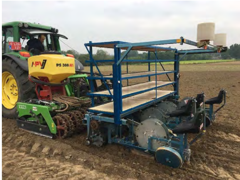
Figuur 8-8: Perdu planter gecombineerd met rotoreg en verkruiemelrol (Crosskill) achteraan de trekker
