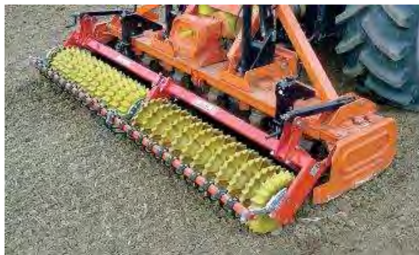
Figuur 4-7: Güttler prisma-rol
