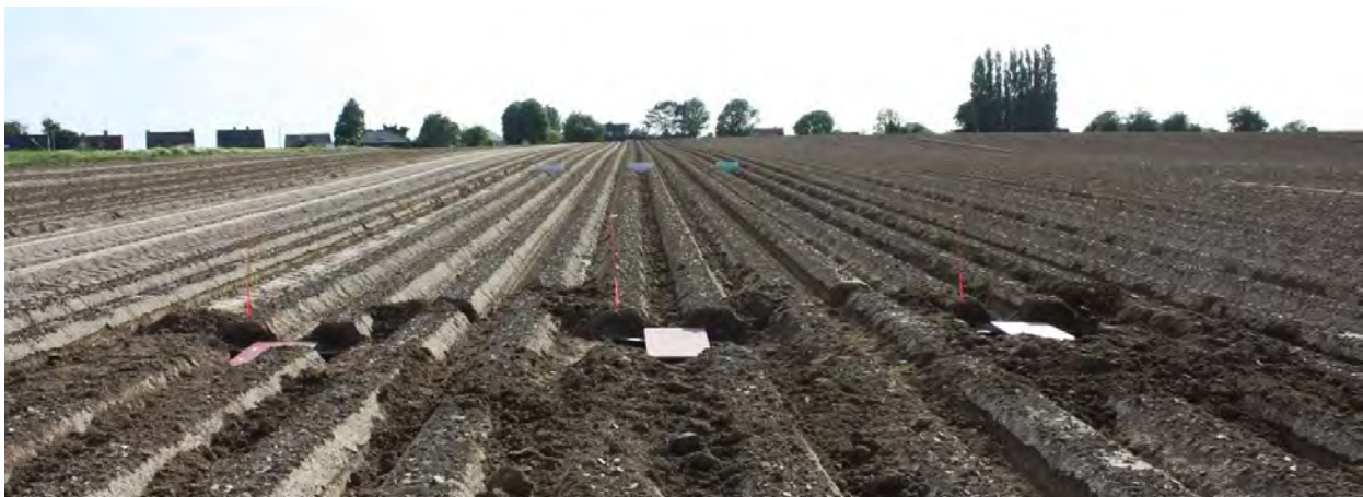
Figuur 9-7: Ingegraven bakken in tussenruggen van behandelingen referentie (links), tand (midden) en tand+drempels (rechts) om run-off end sediment op de vangen 30 m helling opwaarts in de teelt van wortelen.
