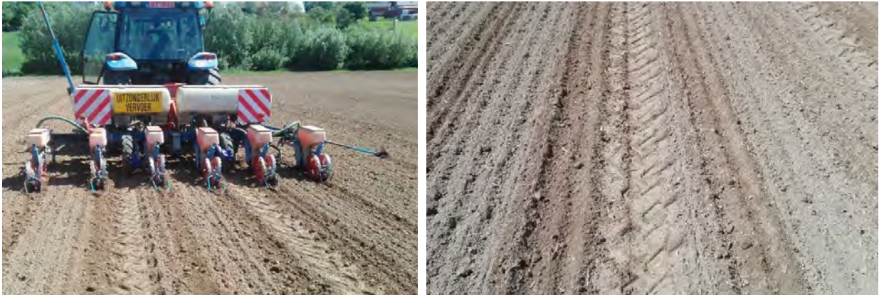
Figuur 1-10: Zicht op de klassieke maïszaaimachine, hoe deze werd gebruikt zonder sporenwissers. Zowel de tractorband als de band van de zaaimachine laten een bandenspoor na.
