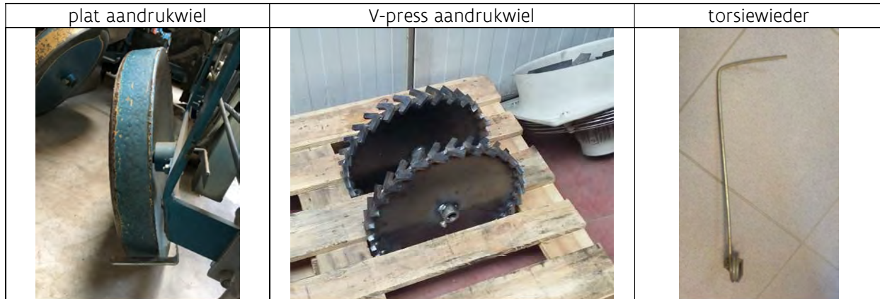
Figuur 8-6: Detailfoto's van plat aandrukwiel (links), V-press aandrukwiel (midden) en torsiewieder (rechts) voor op de planter.
