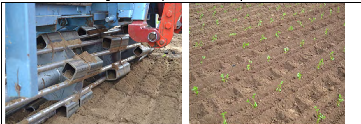
Figuur 7.4: Monteren van metalen elementen op de kooirol en resultaat na aanplanten knolselder (hier niet in combinatie met torsieweiders).
