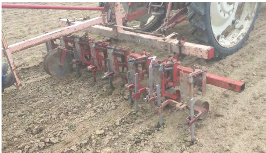
Figuur 4-15: Aangepaste schoffelmachine om te schoffelen in zaaiui met ganzevoet tanden van 4 cm breed.
