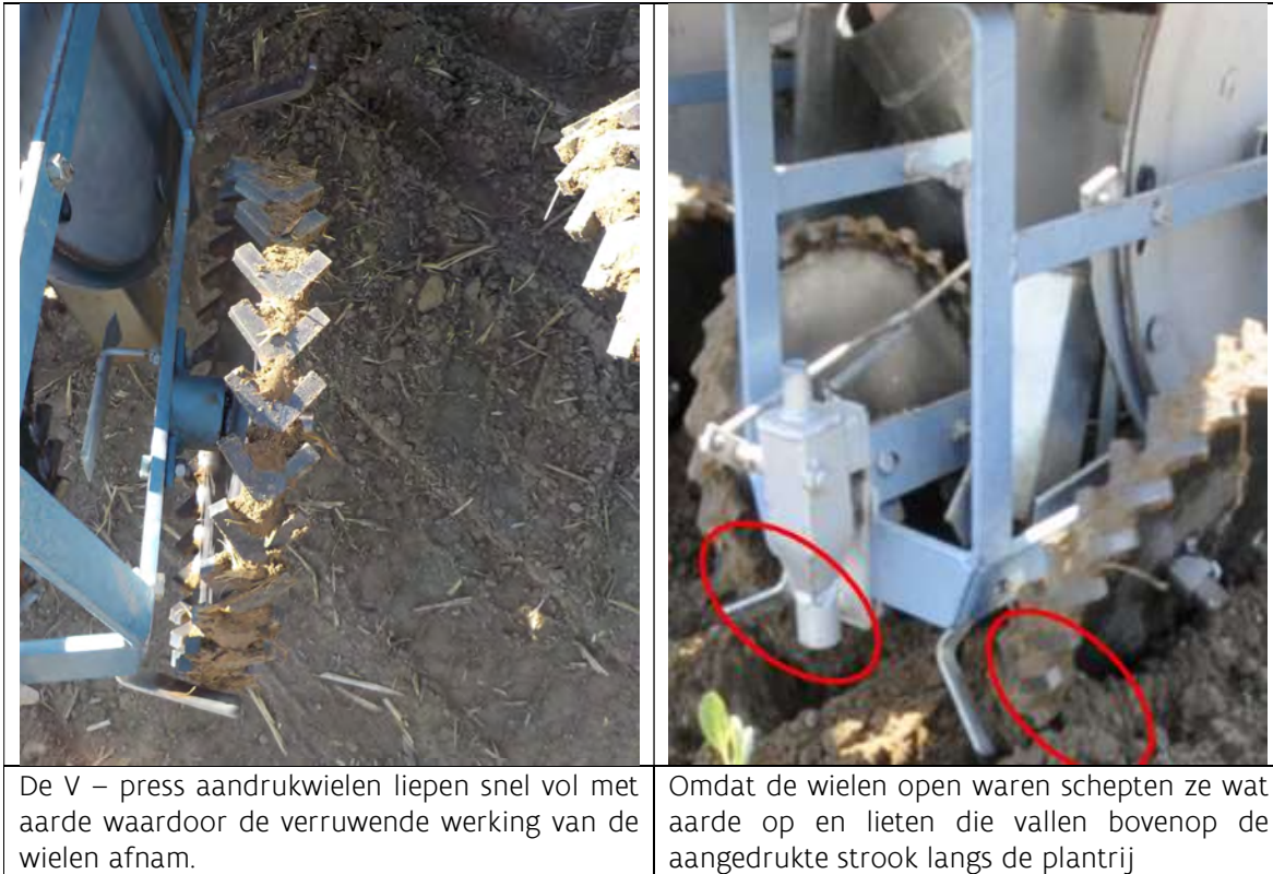
Figuur 6.5: Manier waarop het verruwend effect van de V – press wielen verklaard kan worden.
