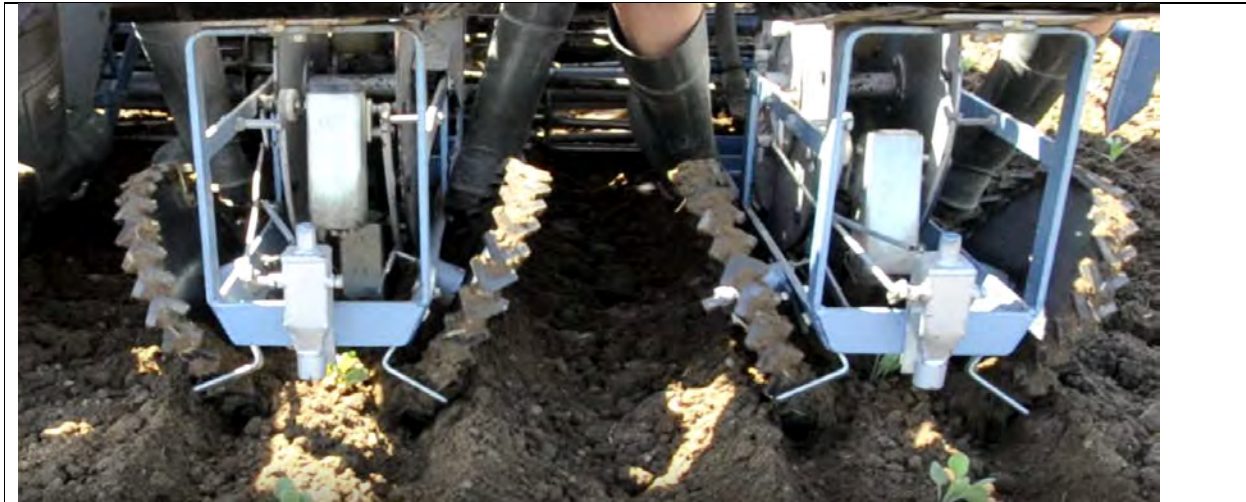
Figuur 6.4 : aandrukwielen met een visgraatpatroon om een ruwere plantrij te bekomen.
