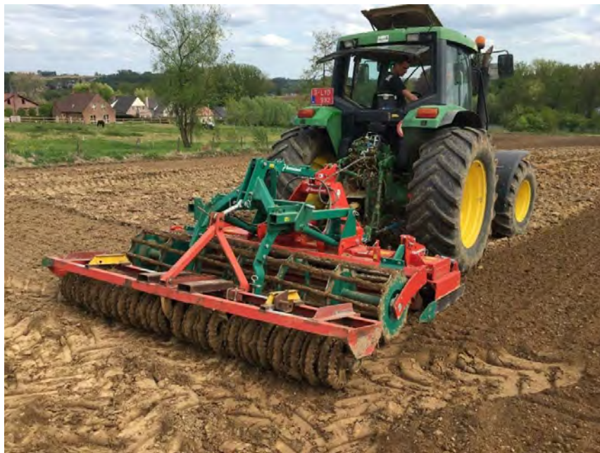
Figuur 4-6: Rotoreg gecombineerd met kooirol en een verkruiemel/verdichtingsrol
