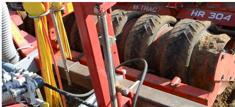
Figuur 4-8: Detail van Kverneland Accord Miniair Nova opbouwzaamachine met rotoreg en platte rol (boven) en detail van de platte rol (onder)
