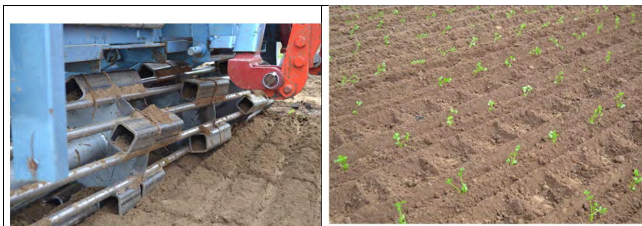
Figuur 7-3: Beeld van de aangepaste kooirol op de plantmachine (L) en het resultaat na planten van de knolselder (R).
