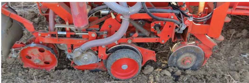
Figuur 2-8: Zicht op een zaaielement van de klassieke maïszaaimachine die werd gebruikt in de veldproef.
