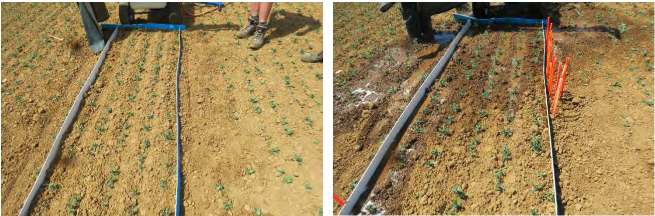
Figuur 5-14: Zicht op een veldje voor de simulatie van run-off (links) en tijdens de meting (rechts).
