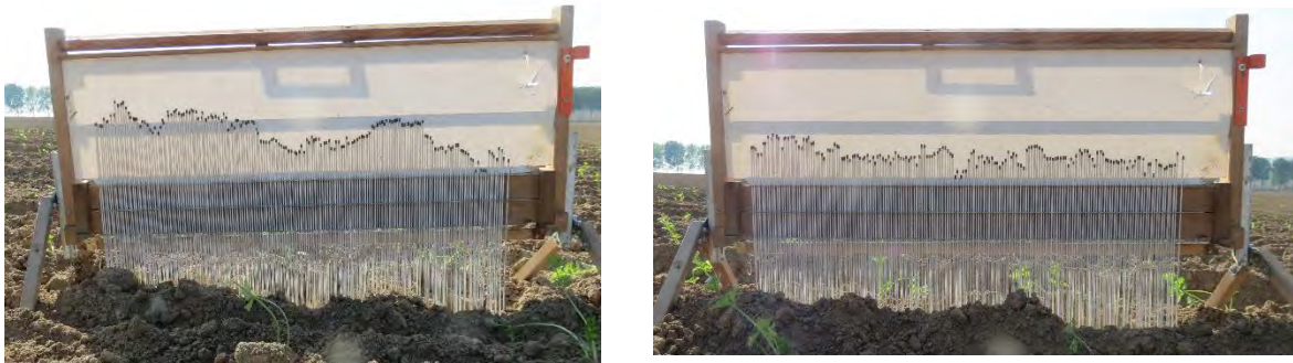
Figuur 7-10 Zicht op de pinmeter bij bepaling van de bodemruwheid in 1-Drempels (links) en 2-Referentie (rechts).
