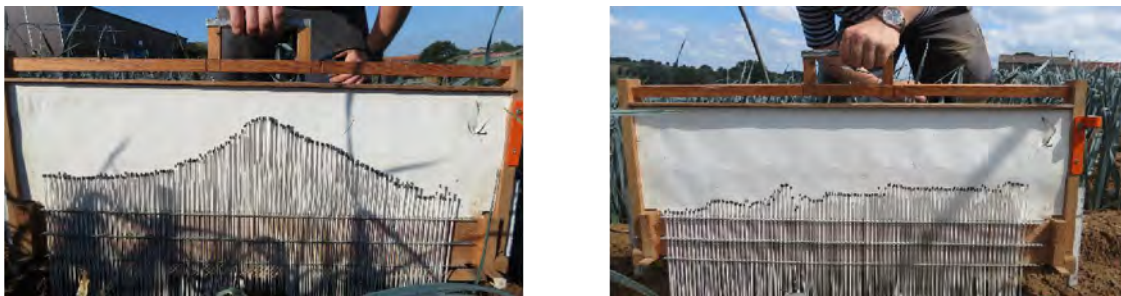
Figuur 8-11: Zicht op de pinmeter bij bepaling van de drempelhoogte in de behandeling 1-Barbutte + ganzevoet (links) en bepaling van de bodemruwheid in behandeling 5-Referentie (rechts).
