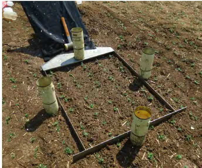
Figuur 5-6: Zicht op een erosieveldje in object 5 (NKB nv + rotoreg) tijdens de regenvalsimulatie.
