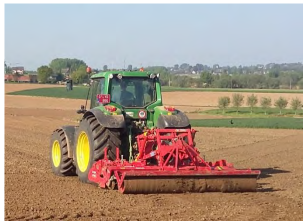
Figuur 4-6: Verkruiemrol (Crosskill) vooraan gecombineerd met een rotoleg gevolgd door een prisma-rol achteraan de trekker (links) en rotoleg gecombineerd met een prisma-rol en een gladde rol achteraan de trekker (rechts)
