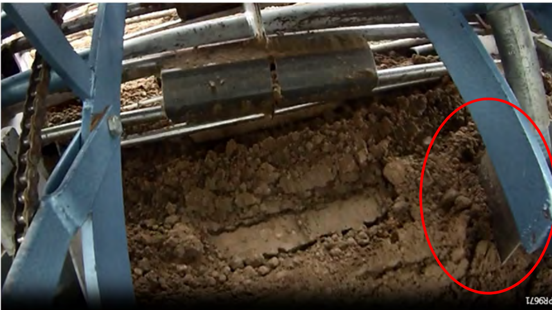
Figuur 7-6: Object 1: drempels. Beeld van de kluitenruimer voor de kouter die een aarden dammetje aflegt langs de planrij die voorkomt dat water vanuit de tussenrij in de planrij stroomt.
