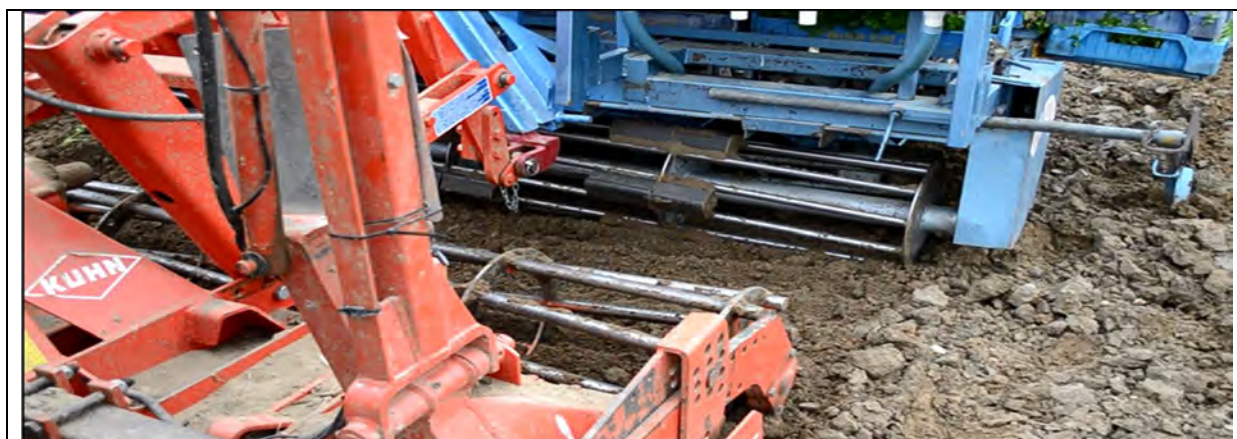
Figuur 7-4: Overzicht van de gebruikte combinatie rotoreg – plantmachine met 2 kooirollen.
