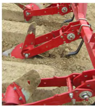
Figuur 85: Dyker, een triltand maakt de aarde los terwijl een gedraaid wiel putten en bulten maakt.
