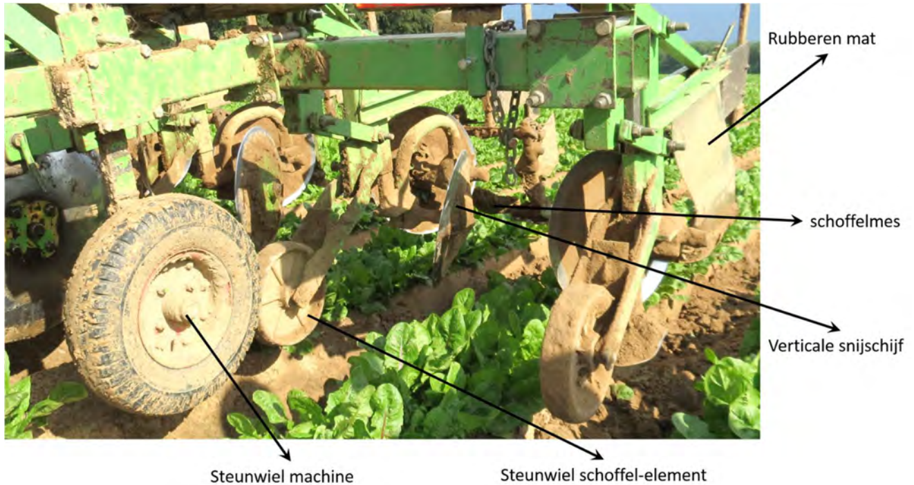
Figuur 114: Opbouw van de schoffelmachine.
