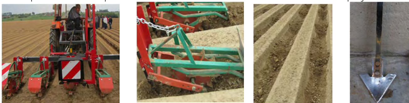
Figuur 88 : Werking van de Barbutte en drempeltjes gevormd met een tand.
