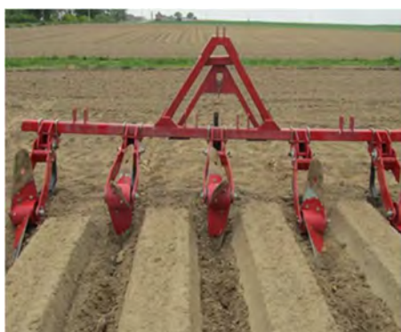
Figuur 85: Dyker, een triltand maakt de aarde los terwijl een gedraaid wiel putten en bulten maakt.
