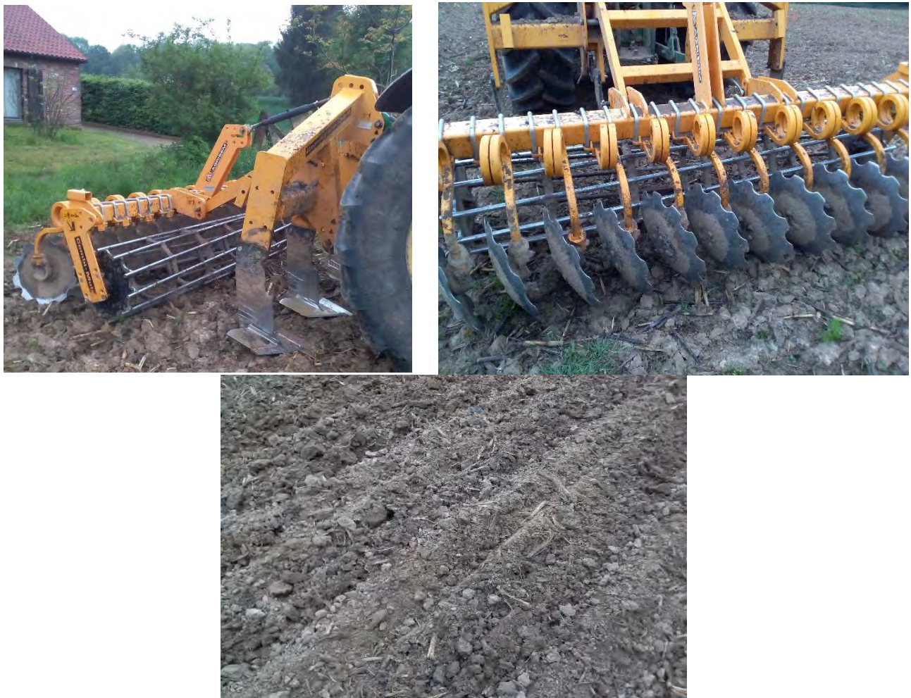
Figuur 33: De opbouw van de Agrisem-cultiplow (links boven), detail van de rij schijven (rechts boven) en zicht op het bovenoppervlak na passage van de machine (onderaan).
