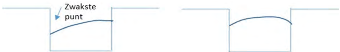
Figuur 92: Schets drempel Barbutte. Links: in spoor drempelmachine, Rechts: buitenspoor drempelmachine, maar in spoor aangiettractor. In het spoor van de drempelmachine lag de drempel scheef waardoor er minder water tegengehouden werd.
