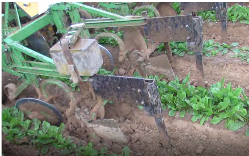
Figuur 115: Vaste tand voor diepe tandbewerking na zaai en bij schoffelen: detail van de tand (links) en de vaste tand zoals gemonteerd voor schoffelen (rechts).
