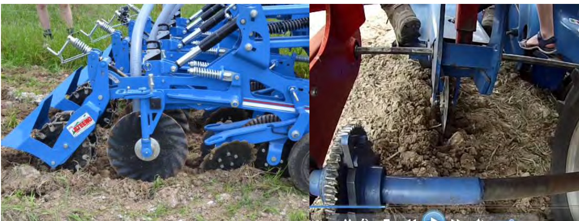
Figuur 163: (L) Strip – tillmachine in een opengescheurde graszode. De gewasruimers ruimden de kluiten (gras en aarde) onvoldoende en de machine liet (aan het oppervlak) onvoldoende verkruidde bodem na (eerder een opengescheurde bodem). (R) foto van de geul die de strip-tillmachine achterlaat in de bodem (vanop de planter).
