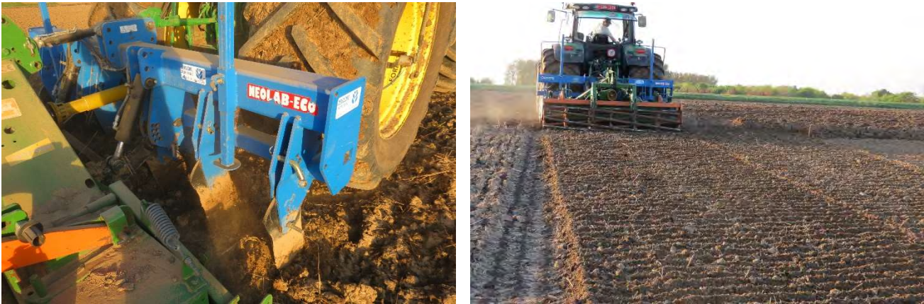
Figuur 9: Aanzicht op de Carré neolab-ECO met 6 micheltanden, gecombineerd met rotoreg met kooirol.
