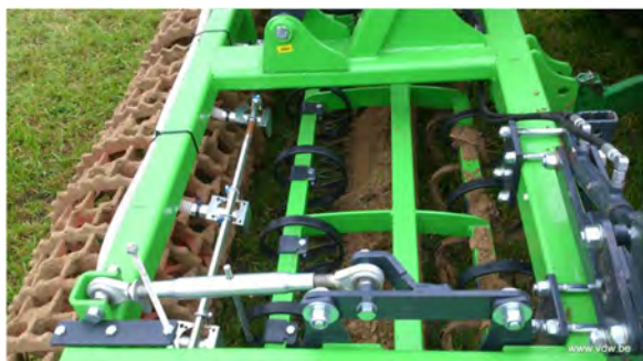
Figuur 136: Combi PCG met 2 rijen triltanden en rol
