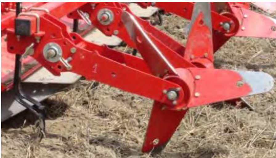
Figuur 117: Zicht op de triltand en schoepen van de Grimme Dycker zoals gemonteerd op een aardappelplantmachine. Dezelfde opbouw werd op een balk gemonteerd en ingezet in de veldproef.
